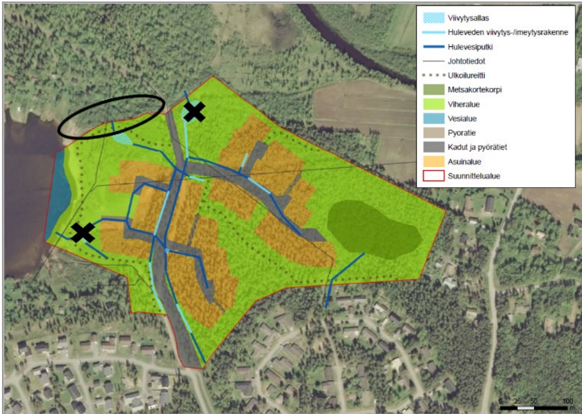
Kuva 8. Ruottalonlahden uudelle asemakaava-alueelle Isoholmiin oli alun perin suunniteltu kolme erillistä viivytysallasta. Kaksi altaista (merkitty rastilla) jätettiin toteuttamatta ja sen sijaan tehtiin suurempi yhtenäinen kosteikko ympäröidylle alueelle lähelle kolmatta etukäteen kaavassa hahmoteltua viivytysallasta. Kuva: Ramboll Finland Oy 2018
