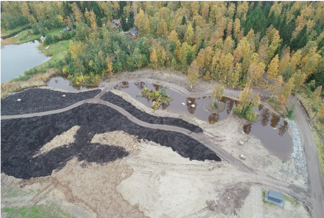
Kuva 11. Droonilla otetusta ilmakuvasta näkee parhaiten hulevesikosteikon sijainnin ja muodon. Kuvan oikeassa laidassa kulkee Ruottalonlahti ja kuvan vasemmassa reunassa kosteikolla käsitellyt hulevedet purkautuvat mereen, Ruottalonlahteen. Virkistysalueelle rakenteilla oleva polkuverkosto kiertää hulevesikosteikon kautta. Kuva: Riikka Nevalainen, Raahen kaupunki, kuvattu 24.9.2020
