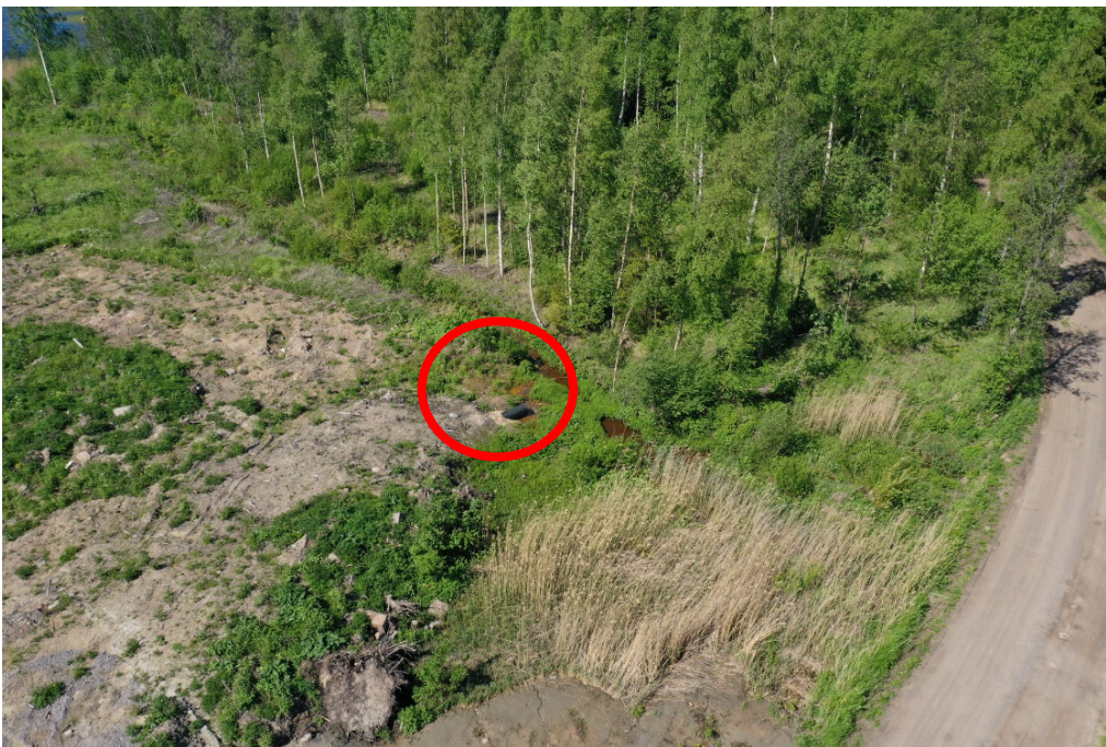
Kuva 10. Hulevesiviemärin purkupaikka Ruottalonlahtien varrella ja siitä mereen laskeva kokoomaaja. Mustan hulevesiputken pää näkyy kuvan keskellä. Tälle paikalle suunniteltu hulevesikosteikko viivyttaa ja käsittelee hulevedet ja tekee alueesta monimuotoisemman. Kuva: Juha Siekkinen, Kosteikkomaailma, kuvattu 8.6.2020
